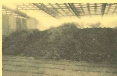
1次発酵槽：堆積発酵4日間
