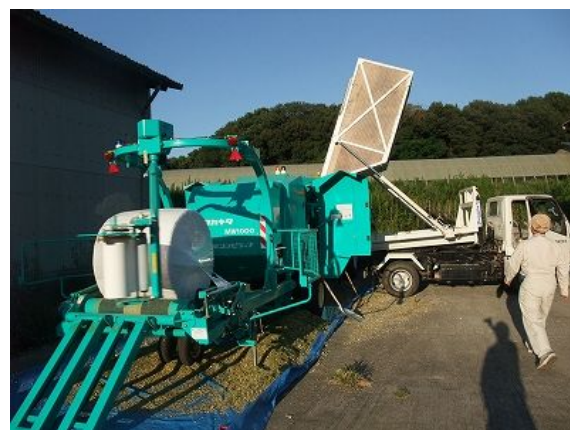
油圧式ダンプとコンビラップによる調製作業
