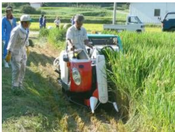
写真5 小型専用収穫機による収穫作業
