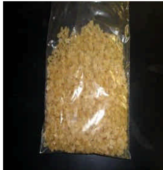
新しい堆肥化用副資材 乾燥ゲル (写真提供: 兵庫県立淡路農業技術センター)
