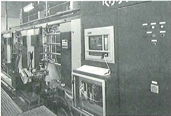
写真 1: 3ボックス型搾乳ロボットシステム
