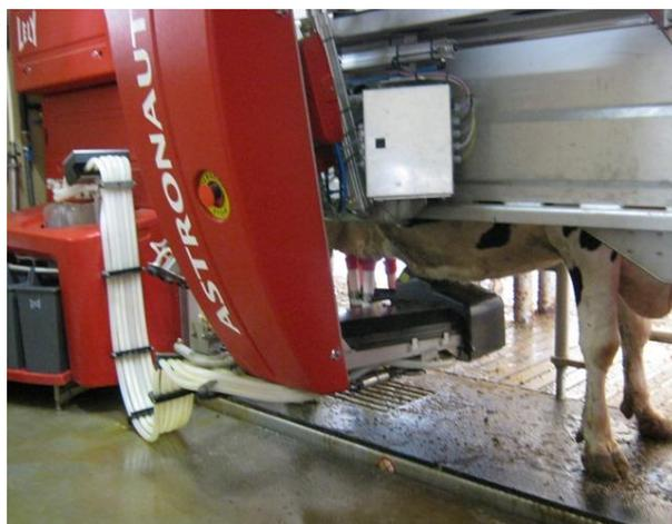
写真2 搾乳中の搾乳ロボット。
